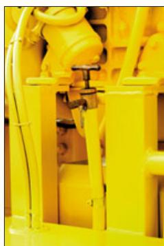
**Pompa a mano per lo svuotamento dell'olio motore montata di serie**
