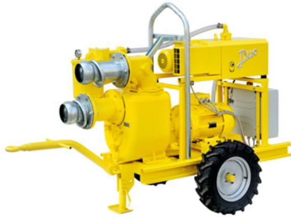
Le pompe vuotoassistite sono gruppi che utilizzano una pompa per vuoto (depressore) per accelerare l'innescamento, cioè, la fase iniziale del pompaggio in cui bisogna togliere l'aria dalla condotta d'aspirazione per fare arrivare il liquido nella pompa. Possono innescarsi "a secco", senza dover riempire preventivamente di acqua il corpo pompa e convogliare agevolmente acqua miscelata con grandi quantità d'aria, per esempio da impianti wellpoint o durante il drenaggio di trincee.
